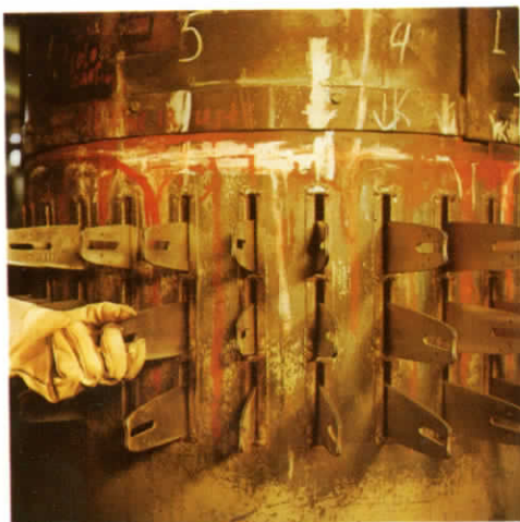
Stanzen, Härten, Fräsen der Nut. Punching, hardening, milling the groove. Découpage, trempe, fraisage de la rainure.
