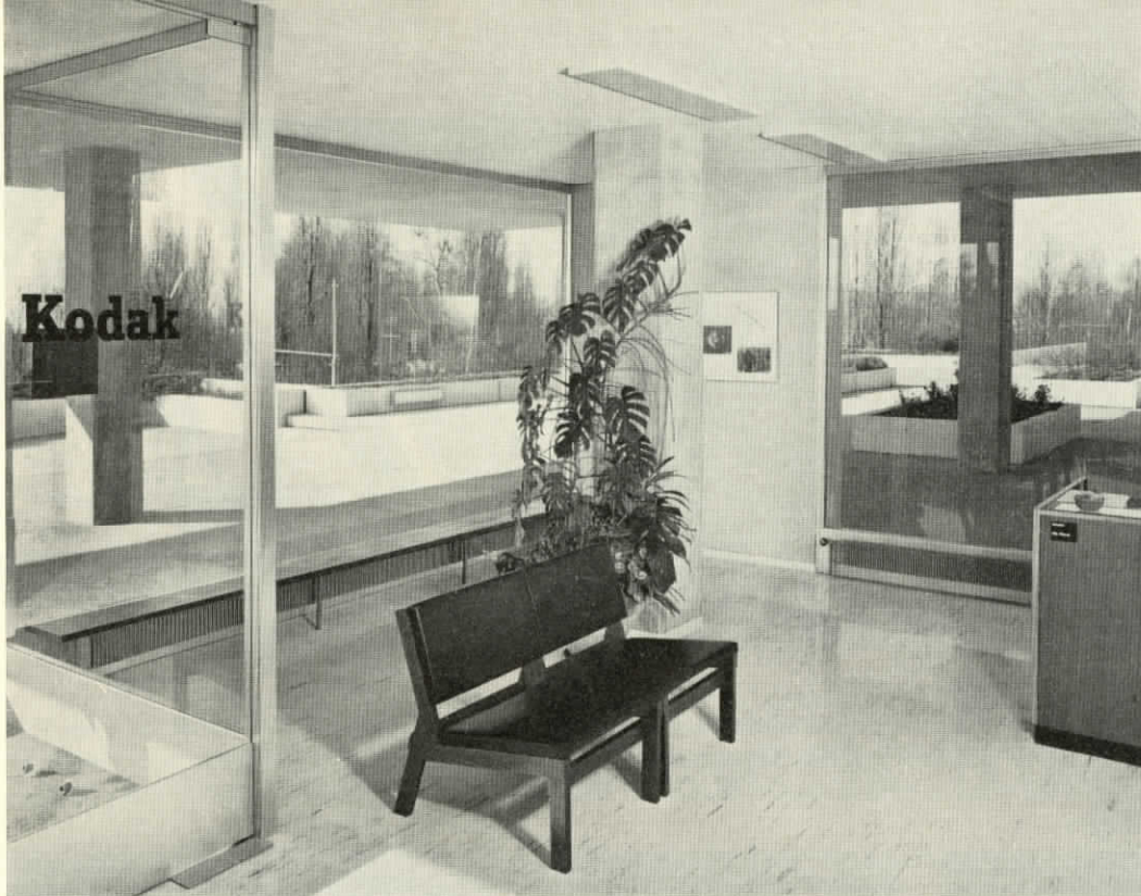
KODAK, LAUSANNE. Eingangshalle — Die äusserst geringe Höhe der auf Füssen montierten Konvektoren gestattet die Verwendung von Glasflächen, die bis zum Fussboden oder, wie im vorliegenden Fall, bis zu einem Sockel reichen. Diese Lösung ist billig und sehr wirksam, da die Wärme der ganzen Glasfläche entlang gleichmässig verteilt wird. Architekten: C. & F. Brugger, Lausanne. Installateur: C. Boulaz & Cie S. A., Lausanne.
