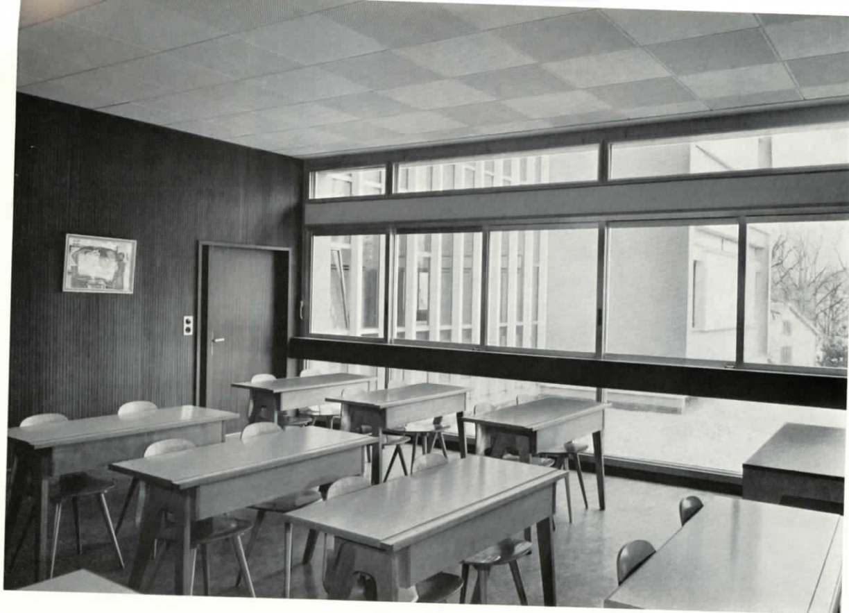
KANTONALES GYMNASIUM, NEUCHÂTEL, NEUES GEBÄUDE — In diesem Klassenzimmer besteht die Heizung erstens : aus einem abgedeckten, den horizontalen Fenstereinfassungen entlang montierten Runtal-Konvektor, der vor allem zum Ausgleich der Fensterabkühlung bestimmt ist ;
