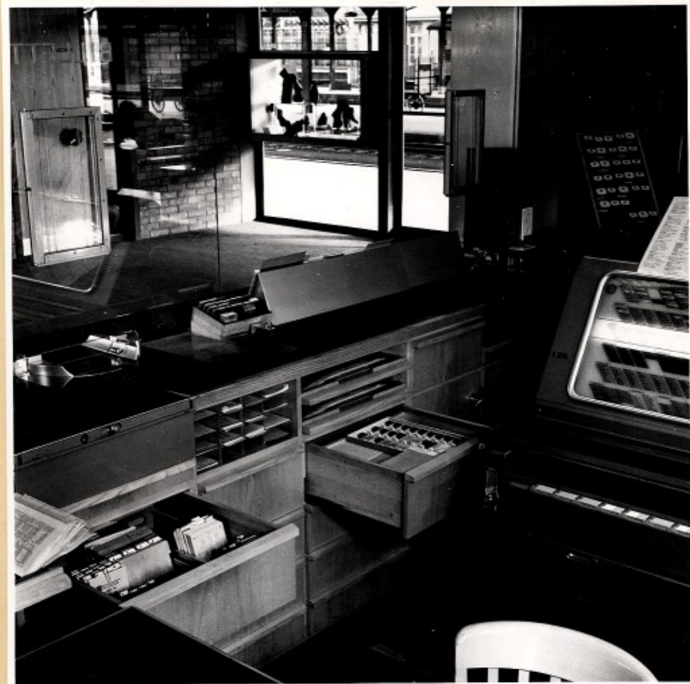
No. 131: Einnehmeri, Schalteranlage, AEG-Drucker, hinten Walzenkasten für EZT-Drucker, in Schublade eingesetzt Bollmannkasten für Spezialbillette, Kartei für bezugsbereite Billette & Abonnemente
